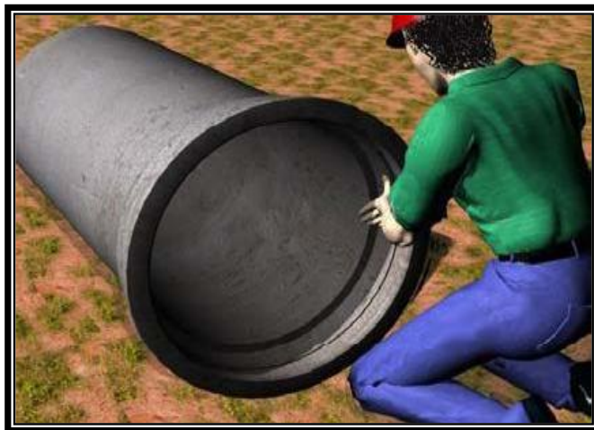
Figura 8- Colocação do anel de borracha
