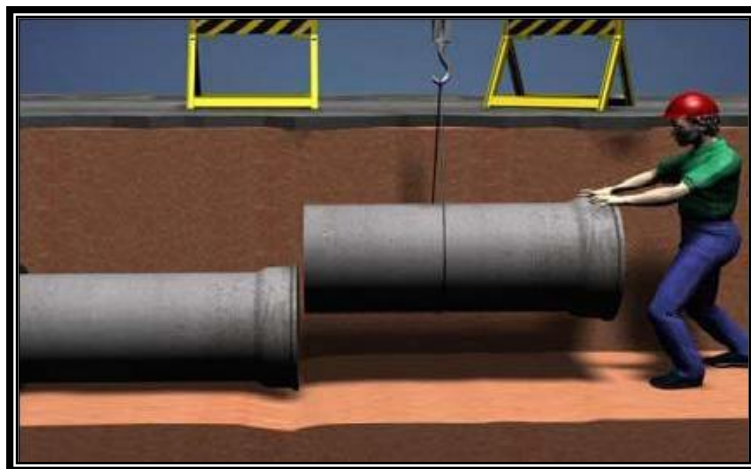
Figura 9 – Acoplamento de tubos de concreto
